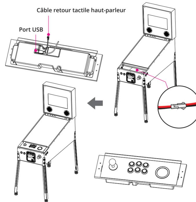
**Étape 4.** Répétez l'étape 1 à l'envers pour ré-assembler la machine. Placez les panneaux latéraux gauche et droite à leur position originale à coté de l'écran principal et attachez-les avec les 10 vis. Une fois les panneaux gauche et droite ré-attachés, remplacez le panneau avant et attachez-le avec les 3 vis.
