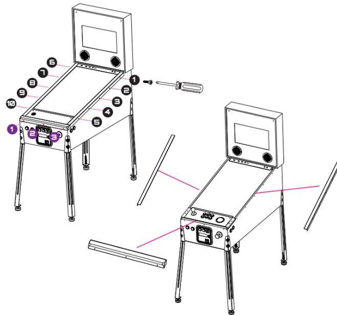
**Étape 2.** retirez les vis et soulevez le panneau de contrôle d'origine. Détachez ensuite avec précaution le câble de connexion du D-pad. Détachez le câble du haut-parleur / retour haptique. Retirez les vis qui maintiennent le câble USB.
