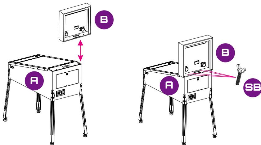
Étape 4. Fixer le panneau arrière au haut du terrain de jeu. visser fermement les 4 vis [SB] dans les trous correspondants. Connecter fermement les fils aux connecteurs correspondants.
