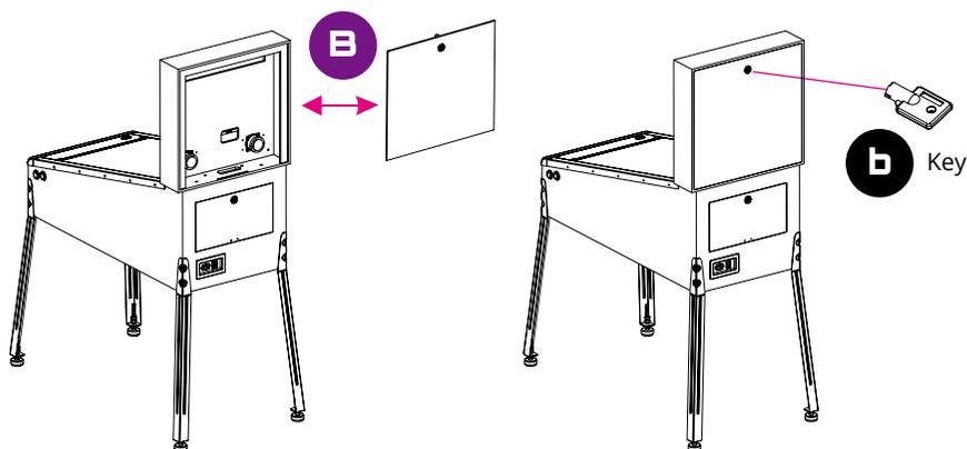
Étape 5. Installer le couvercle du panneau arrière et serrez-le avec la clé [b] fournie.
