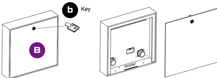
Étape 3. Sortir le panneau arrière et la clé [b] fournie. Utiliser la clé pour ouvrir l'arrière du panneau.
