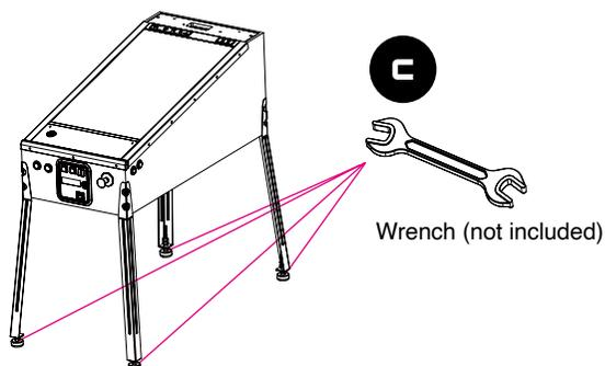
Étape 2. Positionner le terrain de jeu à l'endroit. Utiliser la clé [c] pour régler la hauteur du terrain de jeu à votre goût. Serrer les vis de la base une fois réglé.
