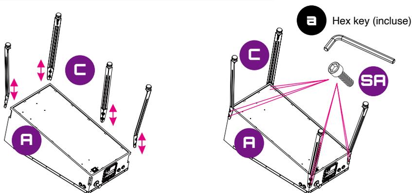
Étape 1. Sortir le terrain de jeu, les pattes et les 8 vis [SA]. Mettre le terrain de jeu à l'envers sur une surface douce. Fixer les pattes au cabinet principal à l'aide des 8 vis [SA].
